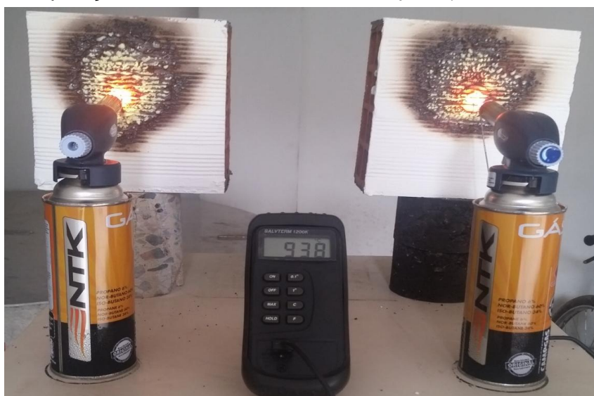
Figuras 3 – Exposição direta a chama de blocos tipo 3 (com tinta intumescente)
