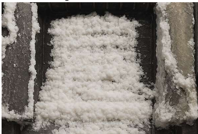
Figuras 5 e 6 – Placas de baterias veicular sulfatadas
