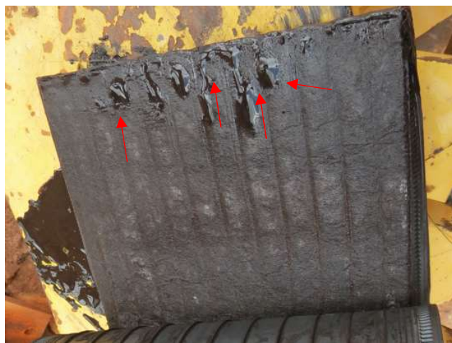
Figuras 14 e 15 - Formação de cristais e borra química.
