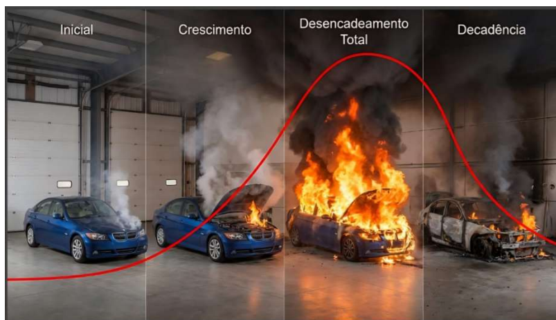
Figura 04 –Evolução do incêndio em bateria de veicular
