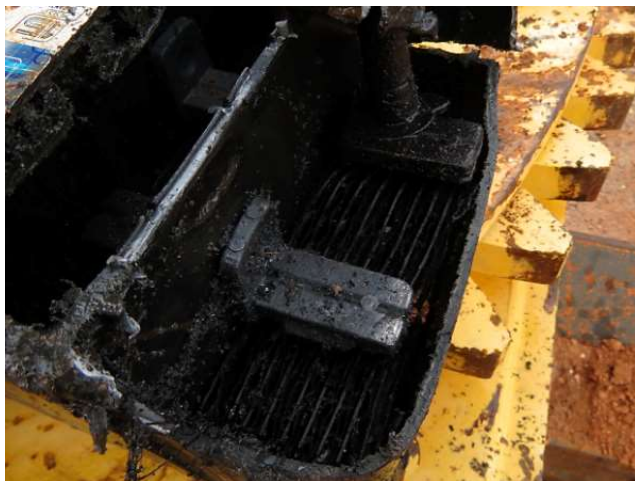
Figuras 12 e 13 - Fragmentação da placa negativa de chumbo, o que promove o curto-circuito interno.
