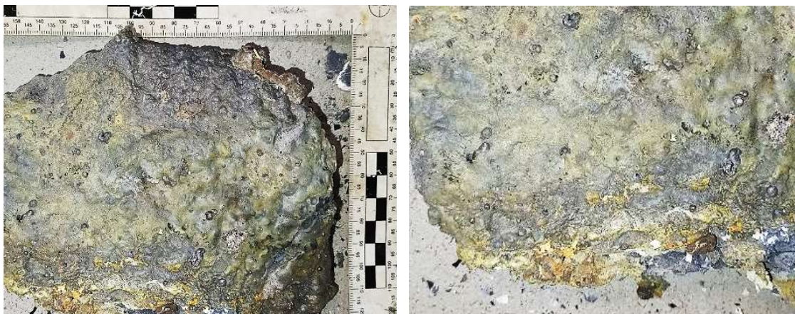
Figuras 16 e 17 - Danos por queima interna/ fusão dos cristais
