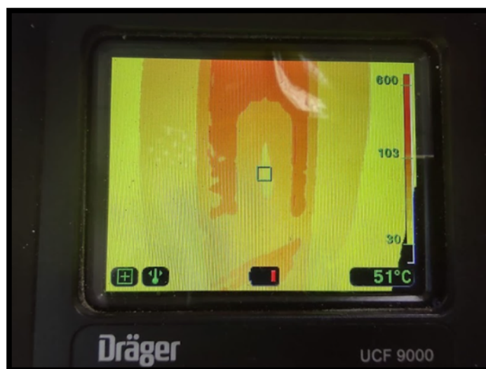
Figura 6 – Imagem da câmera térmica durante o ensaio de um recipiente no interior da estufa.
