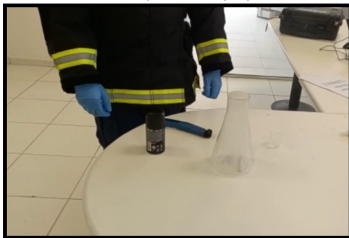
Figura 7 – Momento do ensaio após inserir cigarro em brasas em uma atmosfera enriquecida de propelente.
