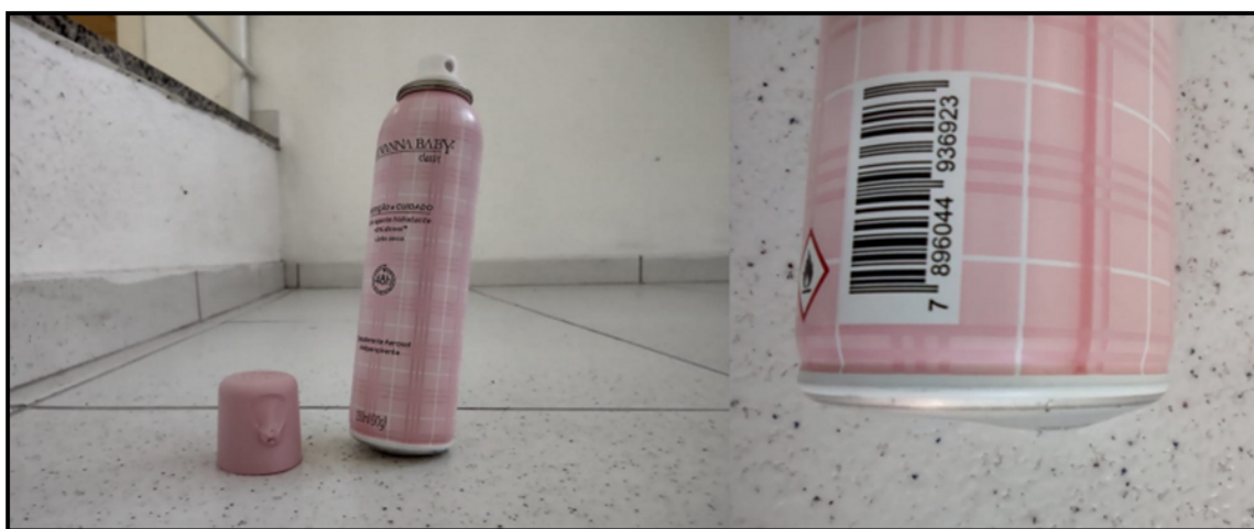
Figura 4 – Deformação do recipiente após a temperatura de exposição de 74° C.
