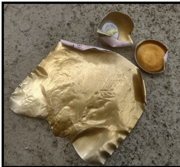
Figura 5 – Detritos do recipiente após a sua ruptura em três partes.
