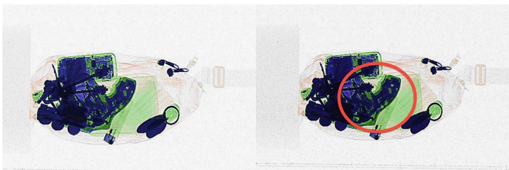
Figura 02: Revólver escondido em uma bagagem. (SIMULSCAN, 2015).
