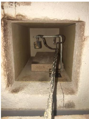
Durante as baterias de testes, as temperaturas do forno e da amostra foram registradas através de um módulo de aquisição e registro de dados, marca Novus, modelo FieldLogger, com oito entradas analógicas, duas saídas a relé e oito portas digitais de entrada ou saída. O módulo de aquisição de dados foi conectado a um computador para acompanhamento dos resultados
