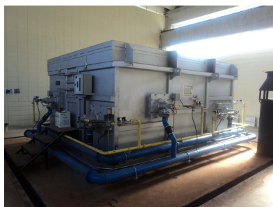
Figura 3 . Forno horizontal para ensaios de estruturas a altas temperaturas, no campus da USP - São Carlos, Brasil.
