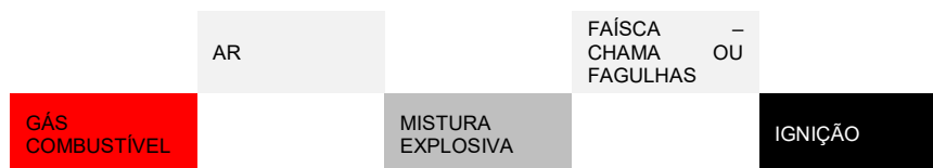
Figura 4. Mecanismo de ignição do combustível gasoso.
