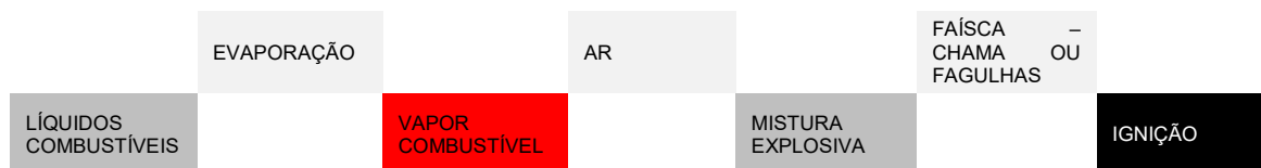
Figura 3. Mecanismo de ignição do combustível líquido.
