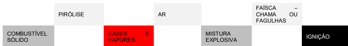
Figura 2. Mecanismo de ignição do combustível sólido.
