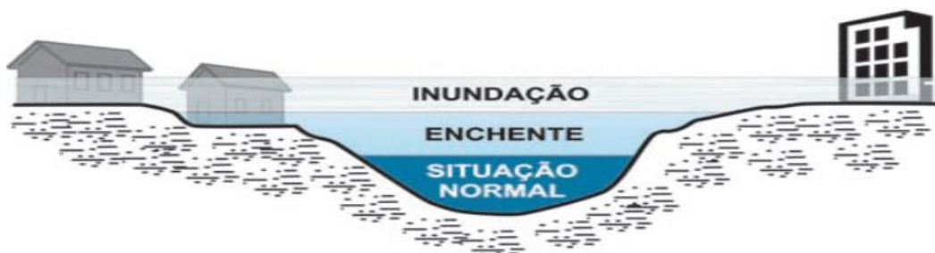
Figura 02: Perfil esquemático do processo de enchente e inundação. Fonte: Ministério das Cidades/IPT, 2007.
