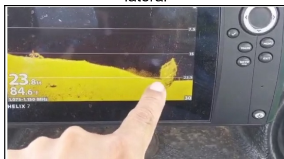
Figura 2 – Alvo sendo localizado com a utilização de um sonar de varredura lateral
