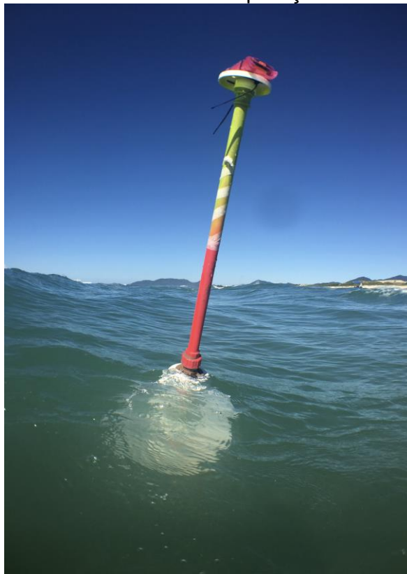
Figura 2. Exemplo de derivador utilizado durante o experimento CampEx. Na imagem é possível visualizar a parte emersa (coloração rosa e verde) e a submersa (cor branca) do mesmo em operação.
