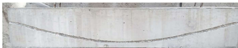
Figuras 10 – Reforço à flexão usando a técnica SNSM
